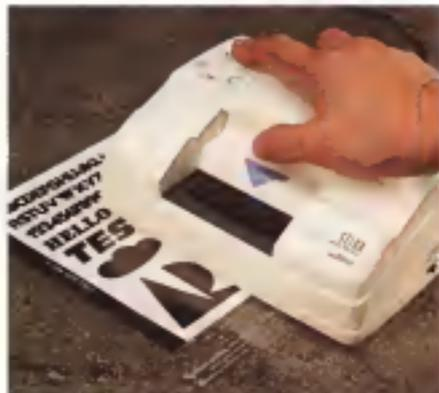
Il funzionamento della Stika è semplice e questo risultato si ottiene in una prima fase di acquisizione l'immagine da memorizzare in un adesivo come si osserva in comune scanner manuale; nella seconda fase si applica il foglietto adesivo nell'apposita finestra e si estrinse che la procedura di taglio automatizza sia posata e sempre
